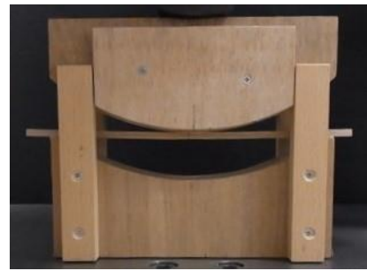
図1 曲げ半径150 mmに曲げる様子
