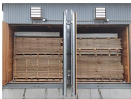
図3 低温乾燥システム
