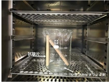
図1. 気相法によるシランカップリング処理
