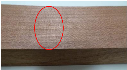
図4 15 mm厚さのウォルナットの圧縮側しわ
