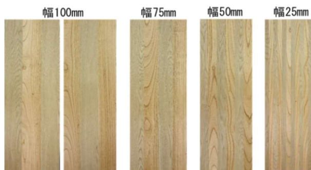
図2 異樹種集成接着試験体
