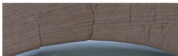
図2 ウォルナット曲げ木の圧縮側しわ (曲げ半径135 mm)
