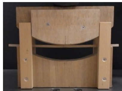
図1 曲げ半径150 mmに曲げる様子
