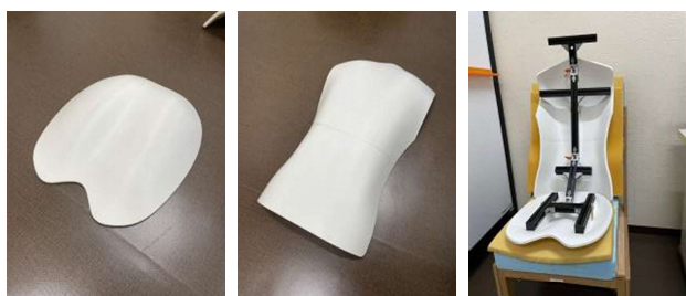
図2 人体形状を模したジグの試作
