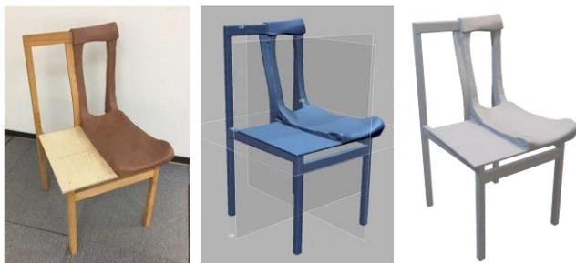
図11 座面、背もたれ形状の変更検討
