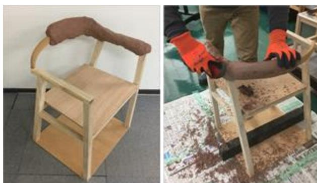
図4 盛り付け(左)、切削加工(右)
