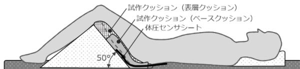
図3 膝屈曲仰臥位の臀部圧力測定
