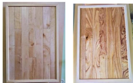
写真4 試作した早生樹パネル (ハンノキ左側とセンダン右側)
