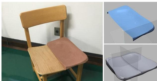
図9 座ぐり座面の形状試作
