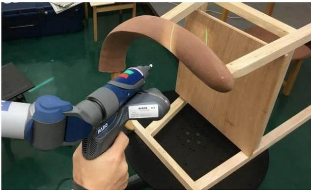
図6 3次元スキャナーによる形状測定
