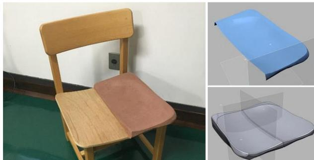
図9 座ぐり座面の形状試作
