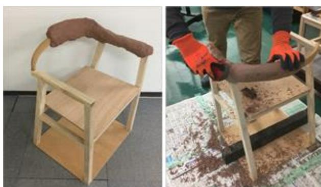
図4 盛り付け(左)、切削加工(右)
