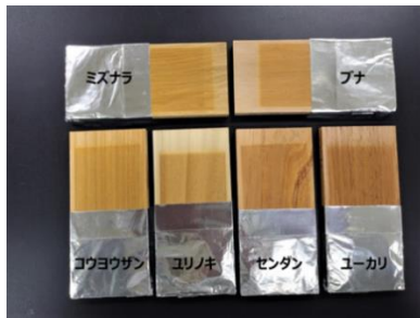
図5 キセノンウェザーメーターによる 200時間後の試験体
