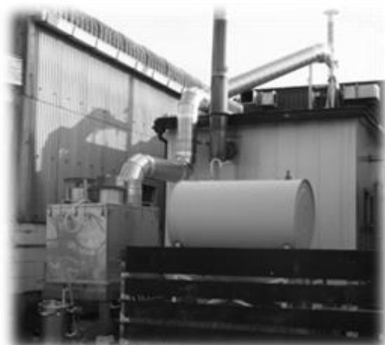
図1 精油回収装置(左側)と木材乾燥機(奥側)
