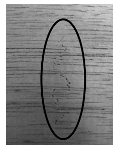
図1 曲げ木引張側に生じる繊維切れ
