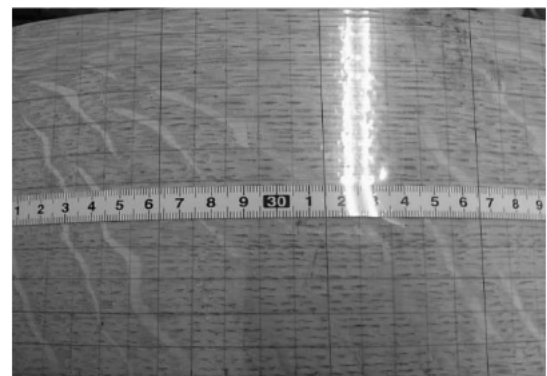
図3 10 mm間隔のグリッド線（曲げ加工後）
