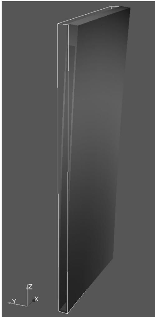
図10 FEMによるWFPの反り変形図
