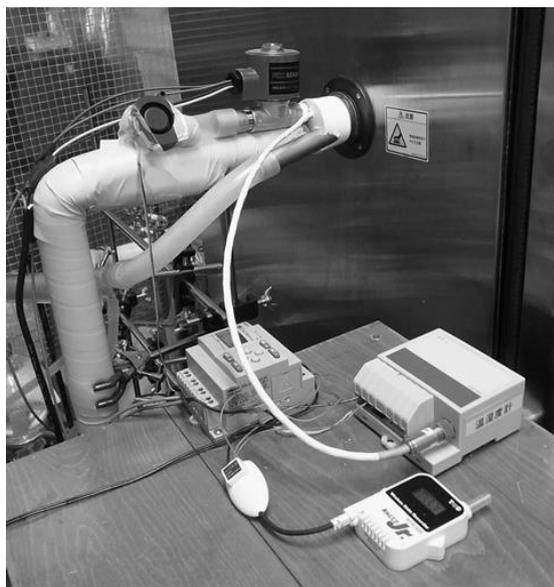
写真1 木材乾燥装置の給排気
