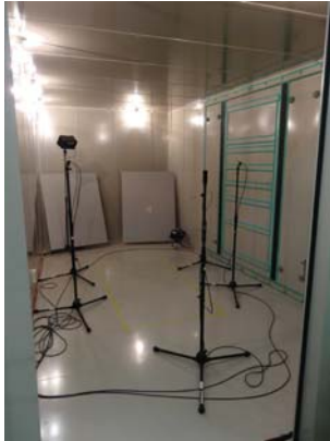
図 6 音響特性評価装置（音源室）
