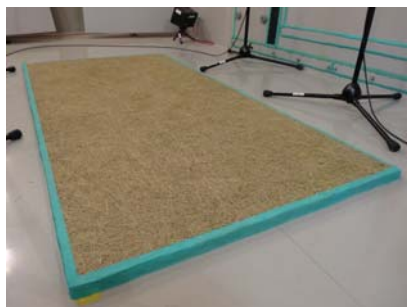
図 11 イグサボードの設置状態
