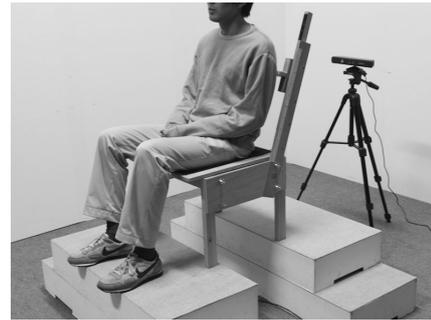
図11 座位形状の測定風景
