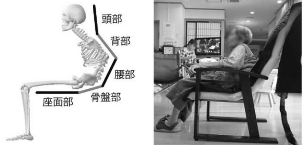
図5 仮合わせ用椅子の構成（左）と仮合わせ時の安定姿勢状態（右）
