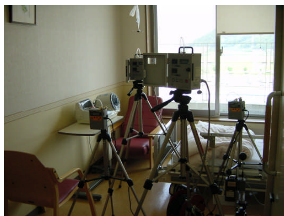
写真 2 既存個室での空気質測定風景
