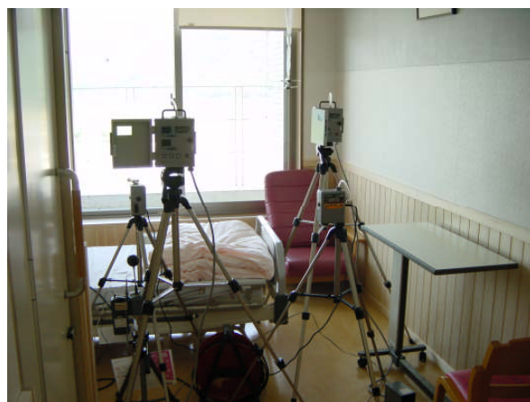
写真 1 改修個室 B での空気質測定風景
