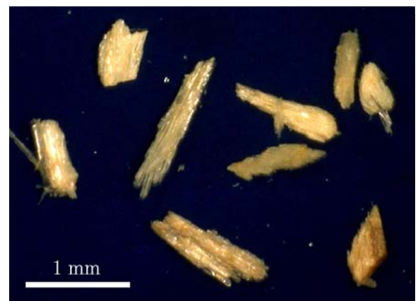
図3 カッターミルにより粉碎された木粉粒子 (全乾スギを \phi 2 mm で粉碎、粒径区分500-1000 \mu m)
