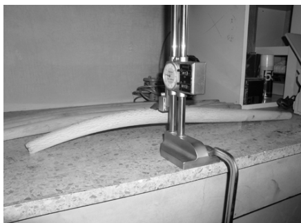
図5a 最大曲げ部の高さ測定
