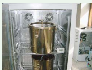
20%チャンバー 28℃、50%相対湿度、換気回数0.5回で測定
