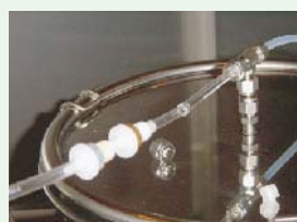
出口から出てくる化学物質を捕集します。
