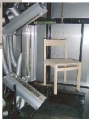
装置内部の水銀ランプ（3灯）
