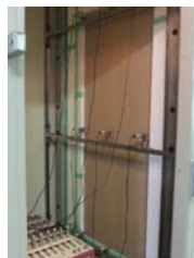
変位計（2室使用のみ）
