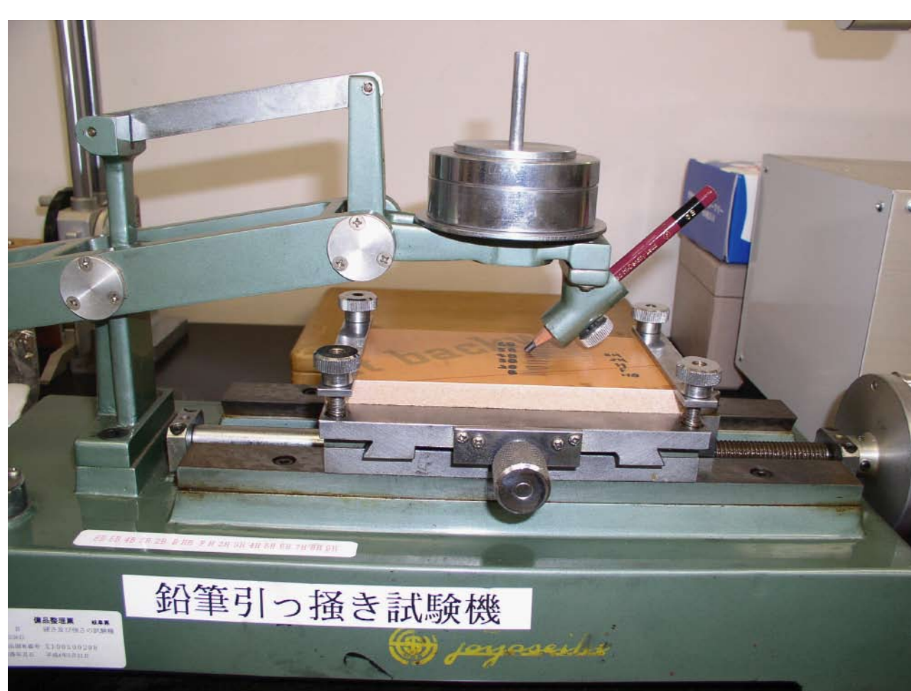
引っかかり硬度試験（鉛筆法）
