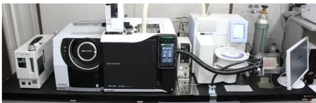
機器分析による揮発性有機化合物の検出と官能分析によるニオイ物質の検出を同時に測定することができ、物体から放散するガスや室内環境空気中のニオイの解明に役立ちます。
