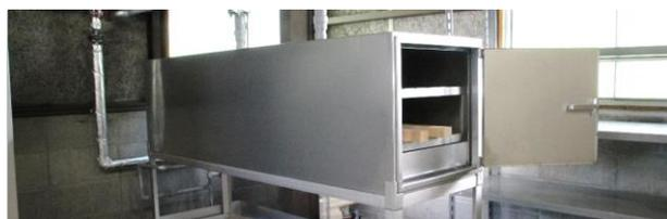
曲げ木の前処理（蒸煮処理）を行う装置で、蒸煮可能な材寸法は幅400mm、高さ120mm、長さ1600mmです。曲げ木に適した状態や、調製条件を検討するために活用します。
