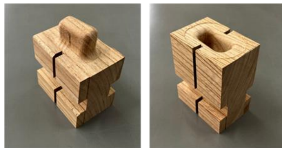
図13 捻じりホゾ構造の加工結果
