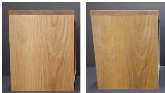
写真4 無処理製品のオイル塗装面側板 左: 試験前、右: 試験49日目
