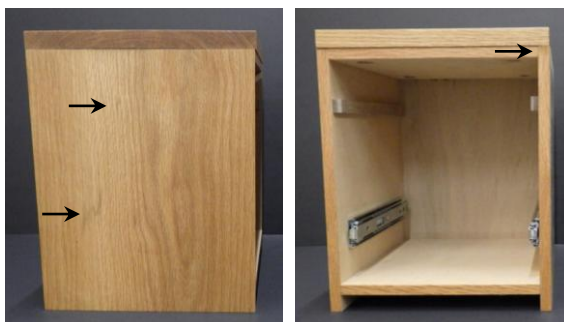
写真5 試験49日目の無処理製品の変色 左: 塗装面側板、右: 縁貼り 変色は矢印箇所
