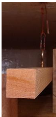
図2 蒸し過程における重量測定の様子
