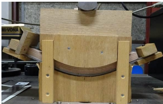
図8 スギの曲げ木 (材15mm厚、帯3枚 スペーサーを除けた状態)
