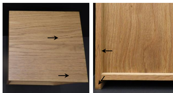
写真7 試験63日目の処理製品 左: 天板、右: 縁貼り(拡大) 変色は矢印箇所
