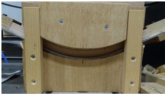
図7 ヒノキの曲げ木 (材15mm厚、帯2枚)
