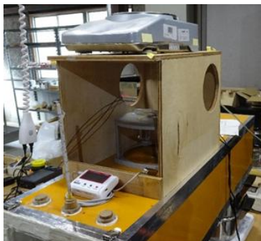
図1 軟化処理（蒸し箱）の様子
