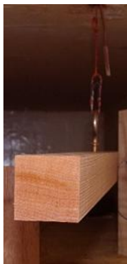
図2 蒸し過程における重量測定の様子
