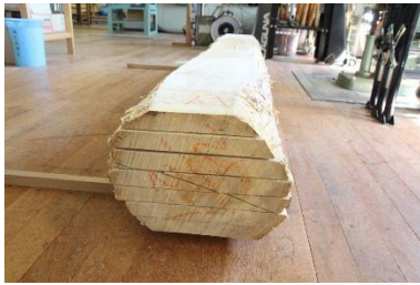
図1 調達した板材群の一例 丸太の中央で半割にしている
