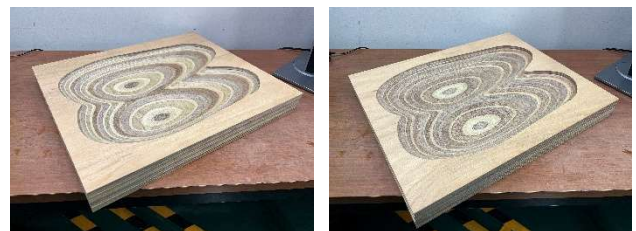
図9 加工結果(左:3軸加工, 右:5軸加工)
