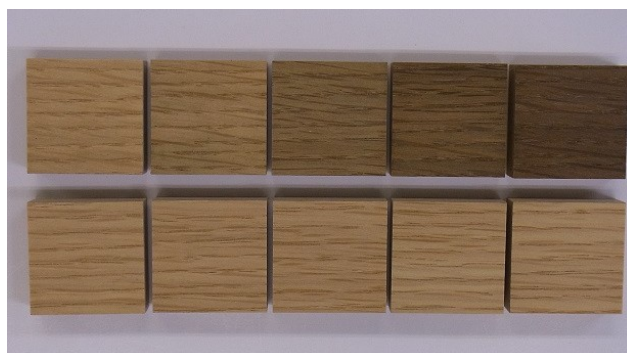
写真2 変色試験後の試験体 (上：無添加試験体、下：1.0%ソルビン酸添加試験体、左から順に7, 14, 21, 28, 35日目)
