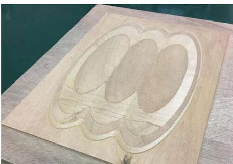
図2 積層合板の切削結果
