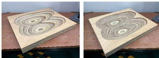
図9 加工結果(左:3軸加工, 右:5軸加工)
