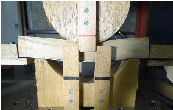
図1 曲げ半径60 mmに曲げる様子
