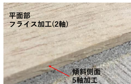
図6 フライス加工部分と傾斜側面(写真)
