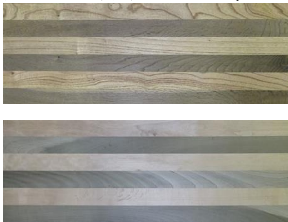
図5 熱処理後異樹種接着集成した試験板 (上: コナラ+センダン、下: ホオノキ+ハンノキ)
