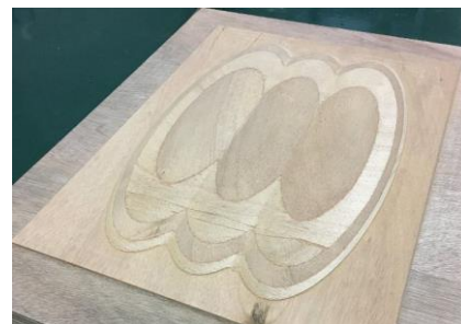
図5 切削された合板積層部材
