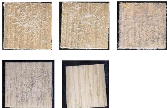
写真2 試験2週間後の試験体化粧面
