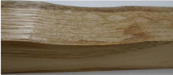
図10 クリの曲げ木による表面の状態
