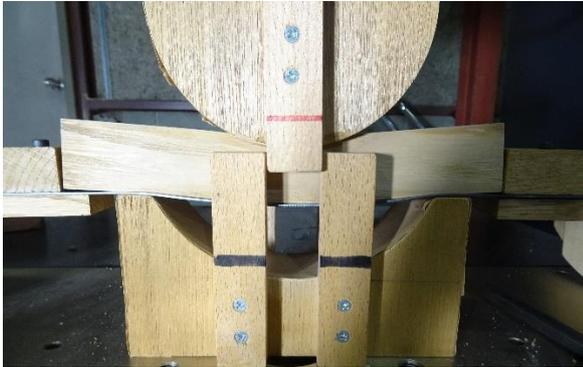
図1 曲げ半径60 mmに曲げる様子
