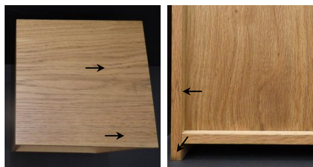
写真7 試験63日目の処理製品 左: 天板、右: 縁貼り(拡大) 変色は矢印箇所
