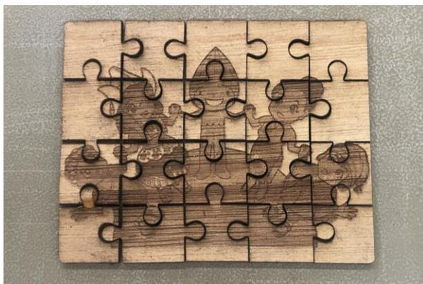
彫刻と切断を組み合わせた加工の例
